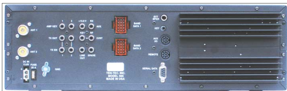
Bild 3: Rückansicht des Orion. Auf den Kühlkörper lässt sich noch ein Lüfter Modell 310 ansetzen, wenn Oberstrich-Dauerbetrieb gefordert wird.
