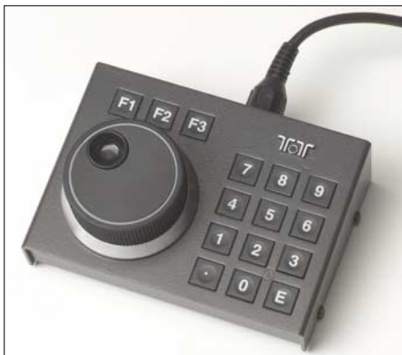
Bild 10: Mit dem optionalen Koder/Tastatur-Modul Modell 302R lässt sich der Orion per Kabel in wichtigen Funktionen fernbedienen – gut für den zweiten OP an der Station. Fotos: Ten-Tec (4), TO (6)
